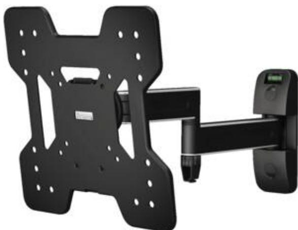
support mural, correspond pour écran plat, 48 cm, 19 pouces, 122 cm, 48 pouces, charge admissible jusqu'à 25 Kg, Vibration amortisseur, niveau à bulle, norme VESA, intervalles entre les trous: 75 x 75 mm, 100 x100 mm, 200 x100 mm, 200 x 200 mm, inclinable, pivotant, 3 articulations, secteur pivotant 360 degrés
